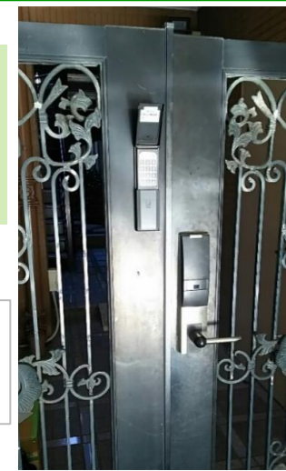
下: インターホン集合機に併設したVリーダー。 ステンレスのBOXはインターホンに合わせてオーダーメイド作成することも可能です。
