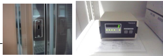
左: 出入口に設置されたセンサー部、右: 計数カウンター本体
